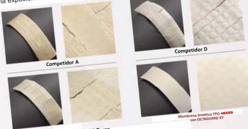
Membrana sintética TPO Texsa • Fue Probada como Producto B • las muestras fueron expuestas a 135°C (Prueba de envejecimiento)
